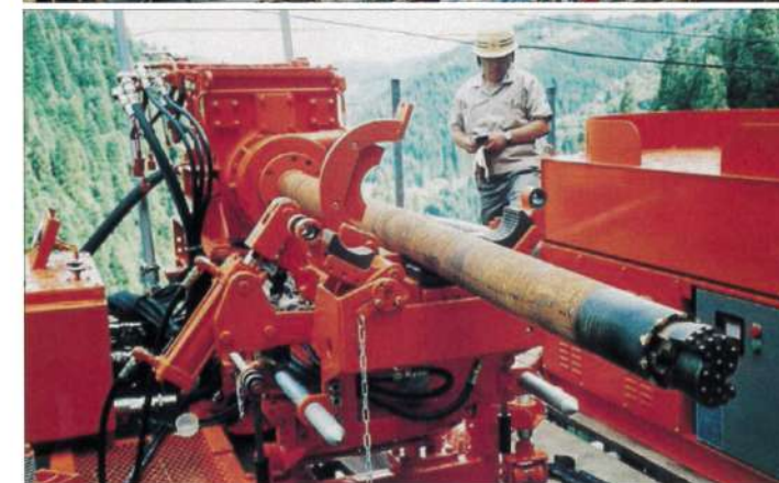
パイプーフ・推進・水抜き・アンカー ダウンザホールハンマーで硬岩層、大深度掘削でも威力を発揮します。トップハンマーにも使用されています。
